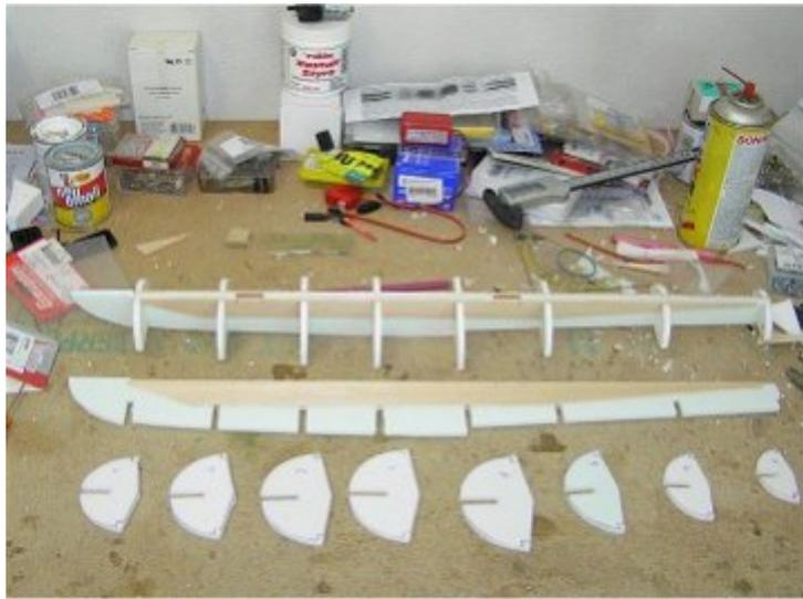
Tipp: vor dem Zuschneiden der Spanten unbedingt eine neue Klinge ins Stanleymesser einsetzen damit das Depron nicht ausfranst.
