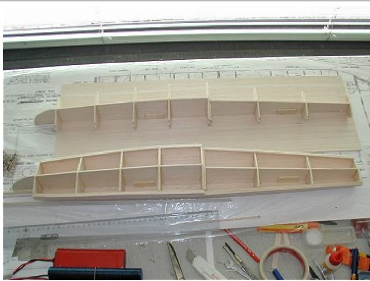
Nach dem Trocknen des Klebers setzt man die Querspanten ein, richtet sie genau aus und verleimt auch diese. Sollen die Schwimmer später auch ein Wasser-Ruder bekommen ist es vorteilhaft den Heckspant aus Sperrholz zu erstellen.
