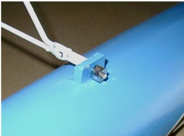
2.) Die Fahrwerksdrähte werden durch in den Schwimmerrücken eingeklebte Sperrholzglaschen gesteckt und mit Stellringen gesichert. Diese Befestigungsvariante erlaubt eine rasche Montage/Demontage der Schwimmer. Die Verschraubung sollte man regelmäßig auf festen Sitz kontrollieren und die Gewinde gelegentlich mit einem Tropfen Öl gegen Korrosion und Rostbefall schützen.
