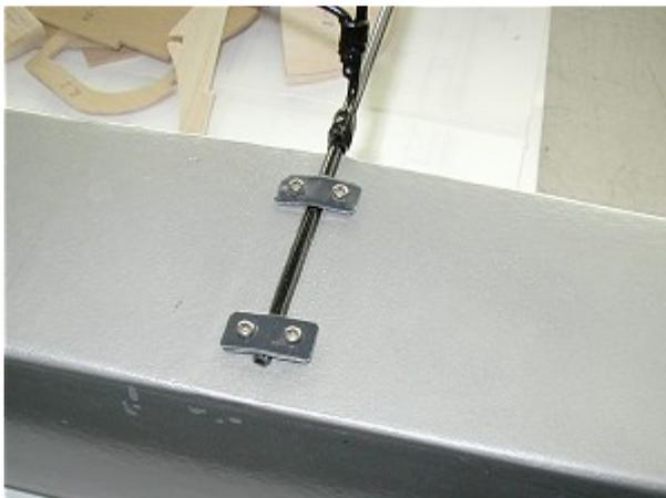
4.) Selbstbau-Schwimmer mit planer Oberseite für ein Oldtimermodell: Mit Hilfe von Sperrholzplättchen entstand an jedem Befestigungspunkt eine Nut an der Schwimmeroberseite zur Aufnahme der Querstreben. Für festen Halt sorgen 2 kleine Alulaschen und 4 Schrauben pro Befestigungspunkt. Werden die Schrauben gelockert, kann man die Schwimmer seitlich abziehen.
