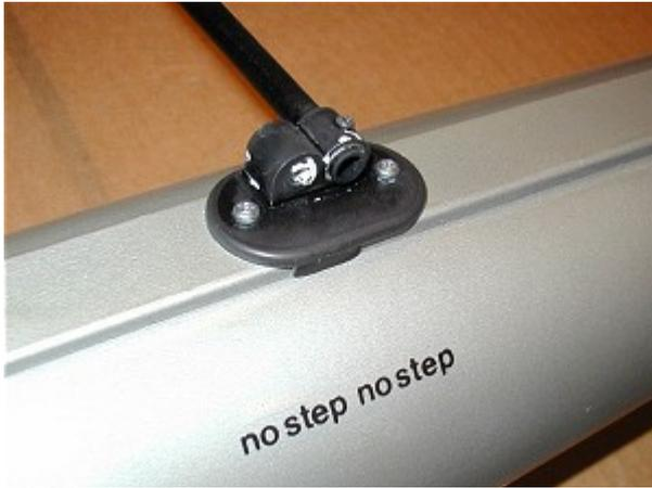
3.) Bei den ABS-Schwimmern aus dem Graupner-Bausatz werden die Querstabilisatoren aus CFK-Röhrchen mittels spezieller Kunststoffschellen mit der Schwimmeroberseite verschraubt.
