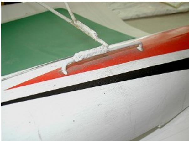
1.) Fahrwerksdraht und Schwimmerbügel (aus Stahldraht) mit Bindendraht umwickelt und weich verlötet. Diese Befestigungsvariante sollte man nur wählen, wenn die endgültige Befestigungsposition genau ermittelt wurde und die Schwimmer (z. B. für den Transport) nicht mehr vom Modell getrennt werden müssen. Vorteil: Hier kann sich garantiert nichts verstellen, lockern, wackelig werden oder ausleiern.
