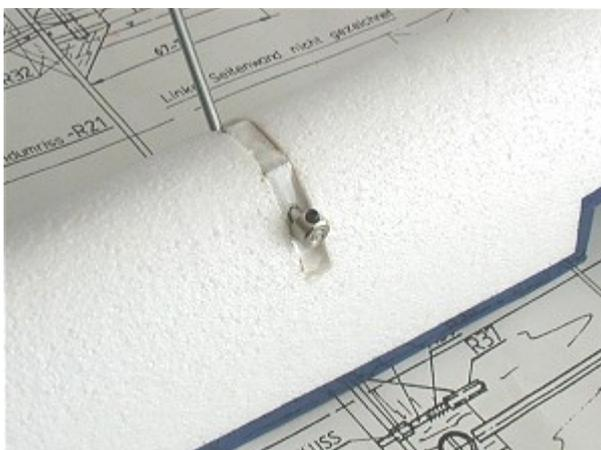
5.) Im Slowflyer-Bereich werden gerne Styropor-Schwimmer eingesetzt. Hier reicht es, ein Klötzchen aus Hartholz oder schichtverleimtem Sperrholz in das Styropor einzusetzen, in welches ein Querloch für die Aufnahme des Fahrwerksdrahts gebohrt wird.
